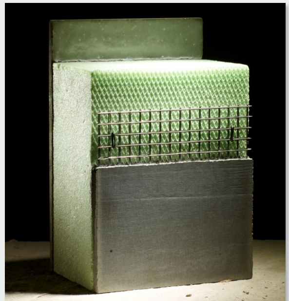
Bild 3. Sandwichelement aus mikrobewertem hochfesten Beton und extrudiertem Polystyrol
