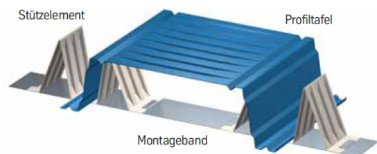
Bild 9. Prinzipdarstellung eines hohen Trapezprofilquerschnitts mit Auflagerstützelementen
