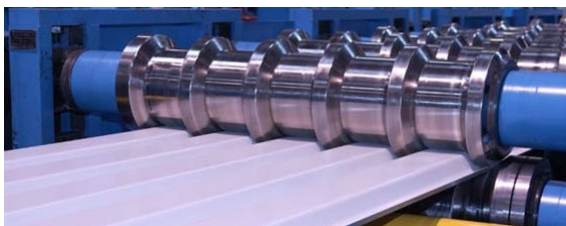
Bild 5. Profilierung der Bleche in einer Rollformanlage
